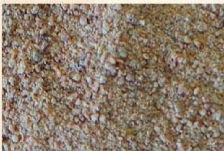
Materiali di origine vulcanica, le ZEOLITI sono contraddistinte da elevato e selettivo potere di scambio cationico ed hanno le capacità di neutralizzare, trattenendoli all'interno della propria struttura, elementi lisciviabili quali l'ammonio, i metalli pesanti e le molecole organiche, di assorbire gas odorosi come l'ammoniaca, l'acido solfidrico ed i mercaptani ed hanno grande efficacia nella riduzione di emissioni odorose provenienti dalle biomasse prodotte da stalle o altro.
